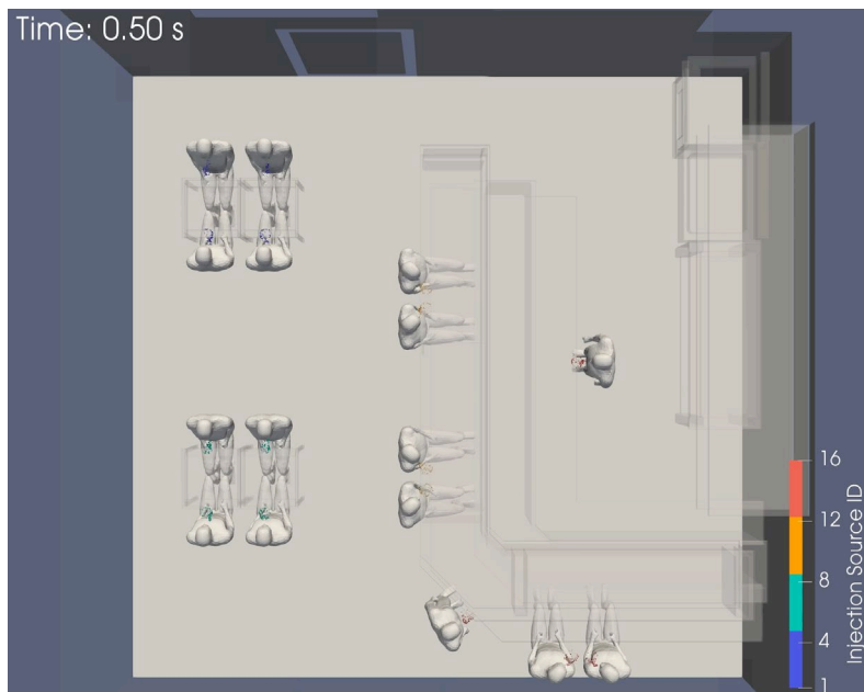
機械換気+キッチンダクト+エアコン
